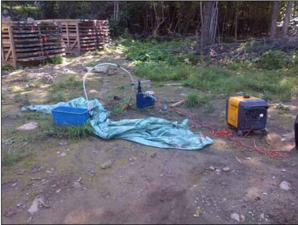
Photo 7 : Essai de purge du DDH13-07
