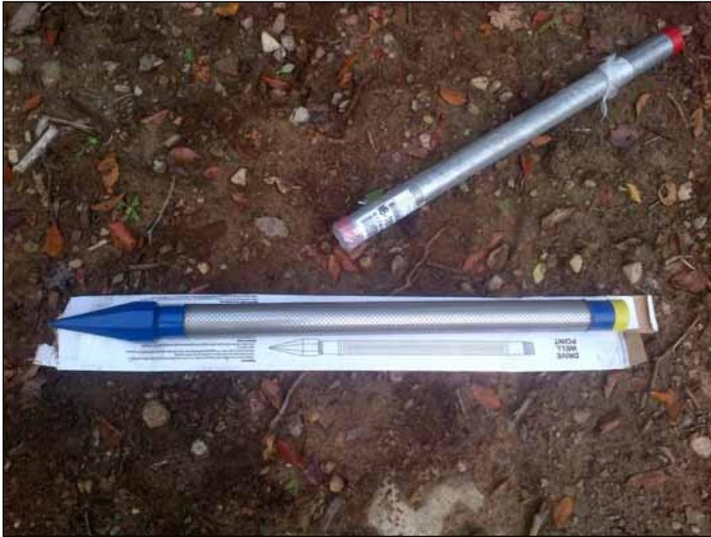
Photo 13 : La pointe filtrante PF1 avant son installation
