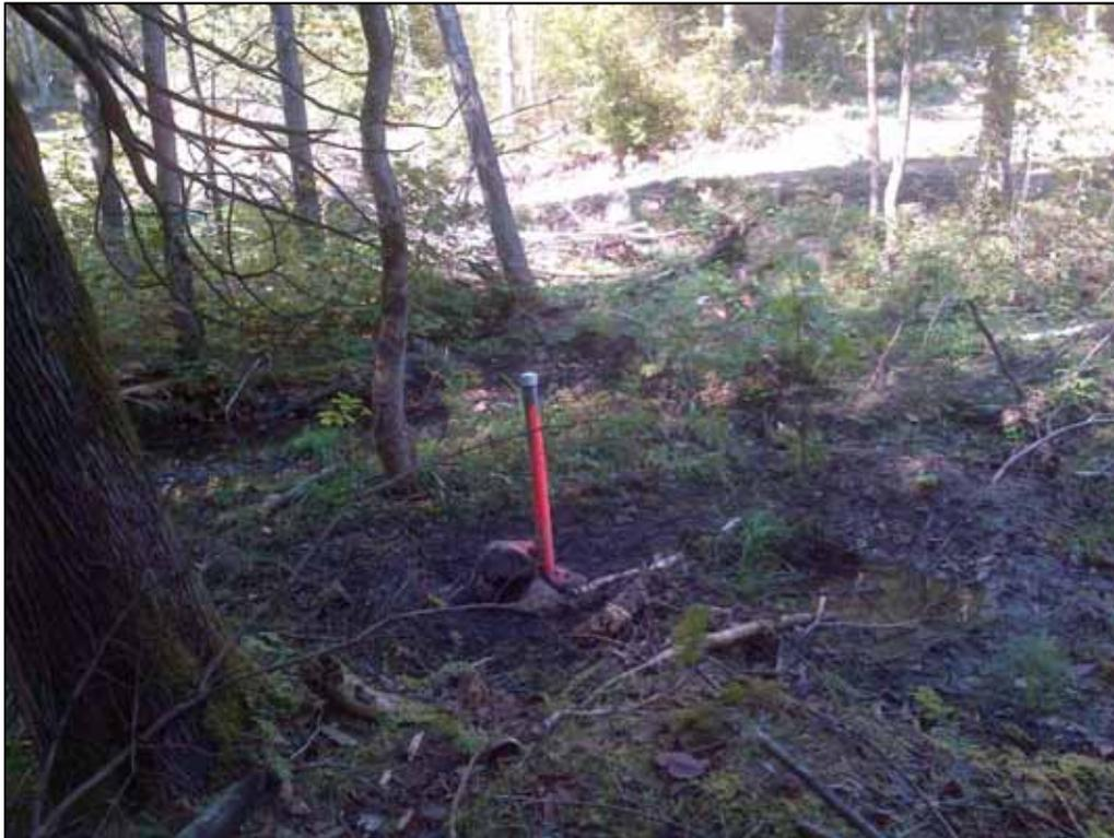
Photo 14 : La pointe filtrante PF1 installée
