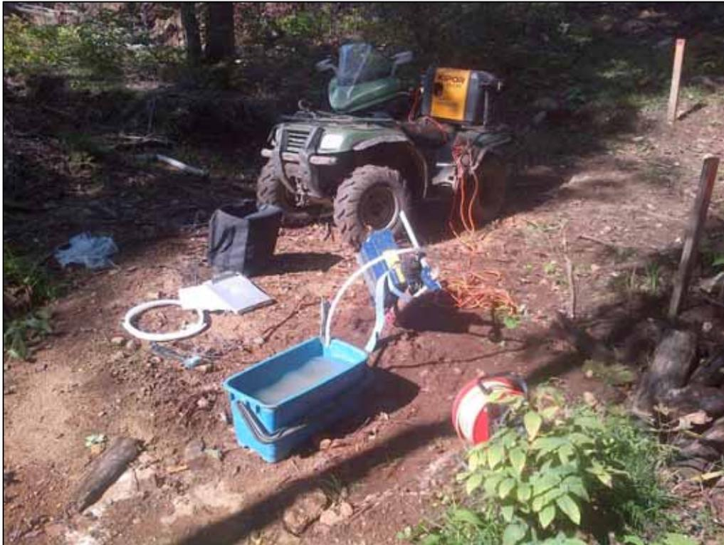
Photo 9 : Purge et échantillonnage du DDH15-88
