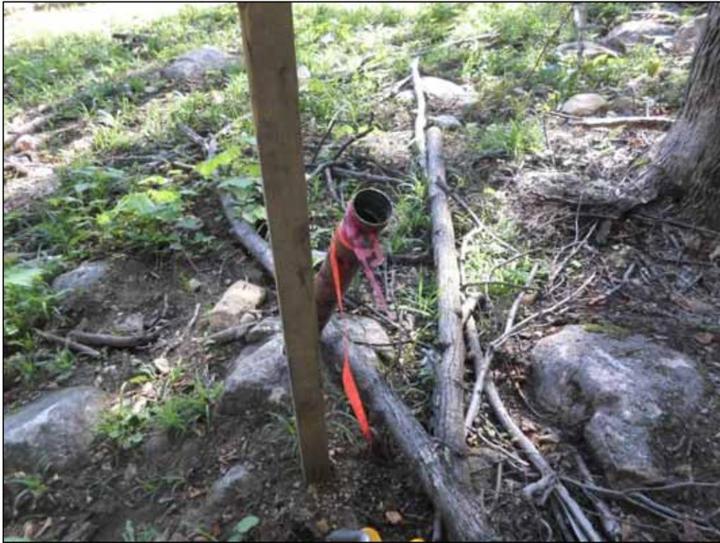
Photo 5 : Forage d'exploration inspecté pour être transformé en puits d'observation, Secteur Sud-Est
