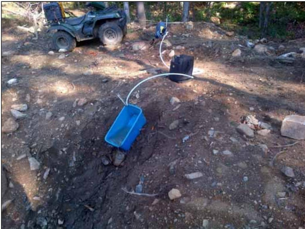
Photo 12 : Purge et échantillonnage dans le DDH15-91b
